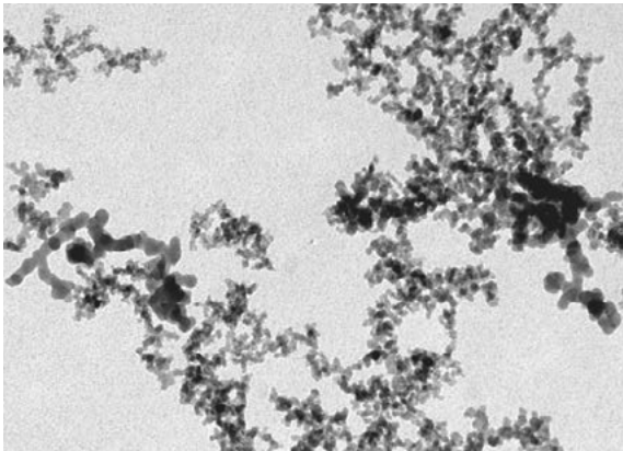
Fig. 1: TEM micrograph of AEROSIL® 150
